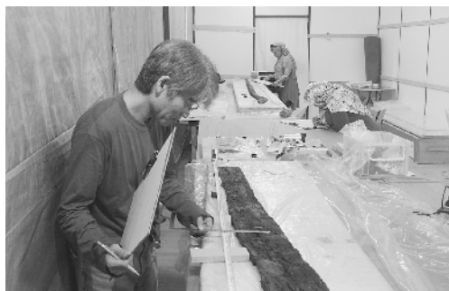
図11 部材のマニュアル測量。部材1点ずつの測量図→パネルの復原図→船の組み立て復原図の順に復原考察を進める。
