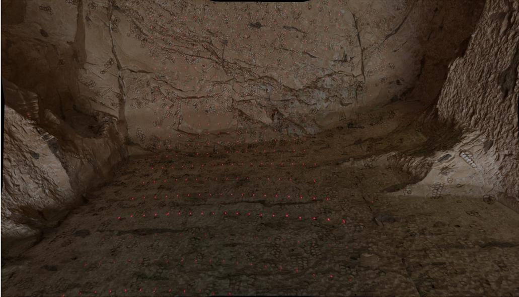
図11 接合補正のためにレーザー・パターンを投影して撮影した
