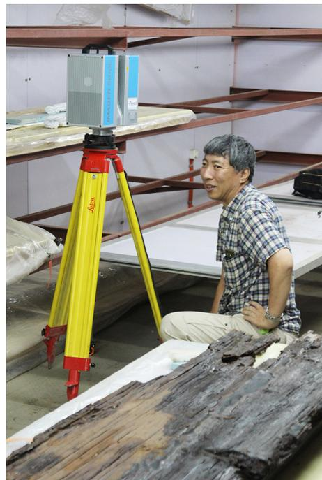
図3 レーザースキャナーによる測量
