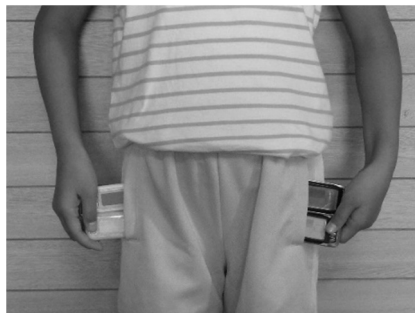
図5 測定機器装着の様子 向かって左がEX200 2機、右がAM140 2機
